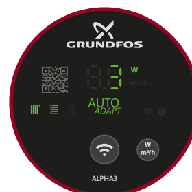
Fig. 20 Aspecto del panel de control en el modo de radiadores y suelo radiante
